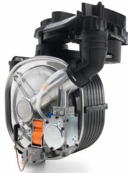
Novi optimizovani & termokompaktni modul (3 and 4-namotaja), sa ventilatorom pozicioniranim iznad primarnog izmenjivača (princip potisa umesto uvlačenja vazduha) za još manje dimenzije uređaja
